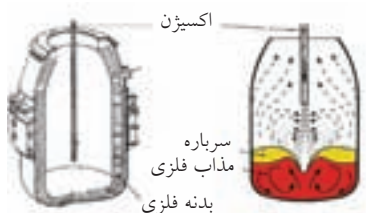
شکل ۲-۸ کوره L-D یکی از روش‌های تولید فولاد.
