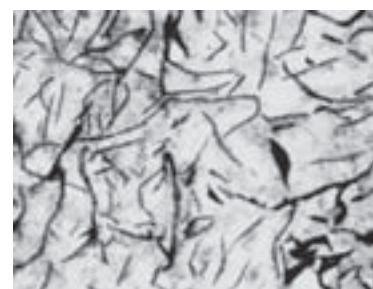
شکل ۲-۴۹ چدن خاکستری با گرافیت ورقه‌ای
