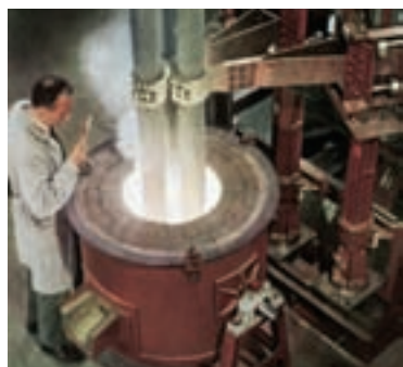
شکل ۱۶-۲ کوره قوس الکتریکی
