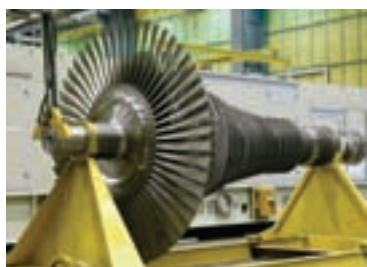
شکل ۲-۳۵ کاربرد فولادهای نسوز در تولید توربین‌های گازی
